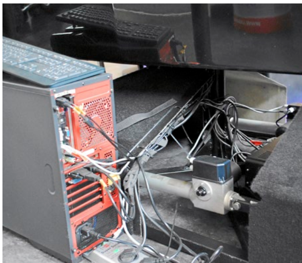
Technik: Highend-PC und Schubstangen für hohe G-Kräfte
